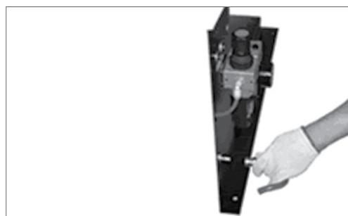
10. Надежно закрепите установку на полу (требования см. выше) при помощи анкерных болтов.
