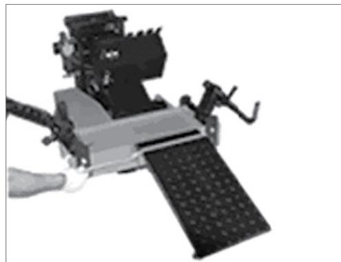
7. Надежно закрепите длинный захват с установленным на нем осветителем на корпусе борторасширителя.
