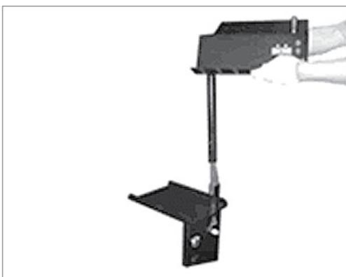
5. Надежно соедините полку для инструментов с пневматическим блоком управления.
