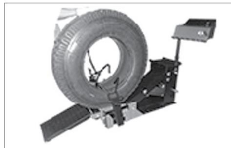
3. В соответствии с размером шины, ремонт которой необходимо произвести, установите механизм фиксации на необходимую высоту. Установите длинный захват так, чтобы он был соединен с рычагом подъемного устройства. Отрегулируйте положение захвата, передвигая рычаг с захватом вверх и вниз для того, чтобы совместить его с одним из семи (7) регулировочных отверстий. Поверните короткий захват внутрь шины и постарайтесь поместить шину посередине между прижимными рычагами.
