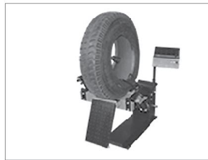
8. После окончания работ, сначала, пожалуйста, потяните вниз джойстик клапана управления платформой, при этом шина опустится, Затем потяните джойстик клапана управления захватом и отведите его. Снимите шину с платформы и скатите ее вниз по аппарели.
