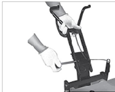
4. Потяните джойстик клапана управления расширением шины в сторону растяжения и растяните шину на необходимую ширину. Шина, вероятно, будет отходить от корпуса борторасширителя, если захват установлен слишком высоко. Продолжайте работу после переустановки захвата в более низкое положение.
